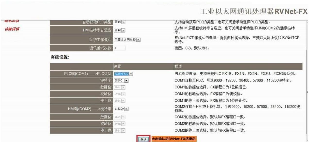
自动获取 PLC 类型：默认为“开启”，“开启”状态下不需要再去设置“PLC 端(COM1)——>PLC 类型”，将自动识别 PLC 型号。
